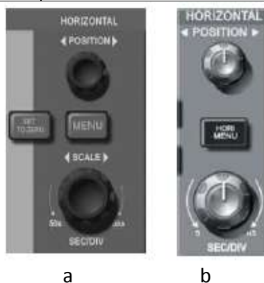
Fig. 2-11 Interfata pentru setare pe orizontala la osciloscoape cu ecran de: 5.7 inch (a) sau 7 inch (b)
