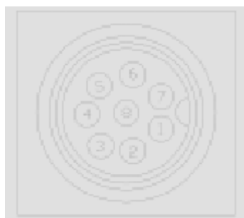
Fig.3 Numarul pinilor din priza microfonului vazuti din spatele receptaculului
